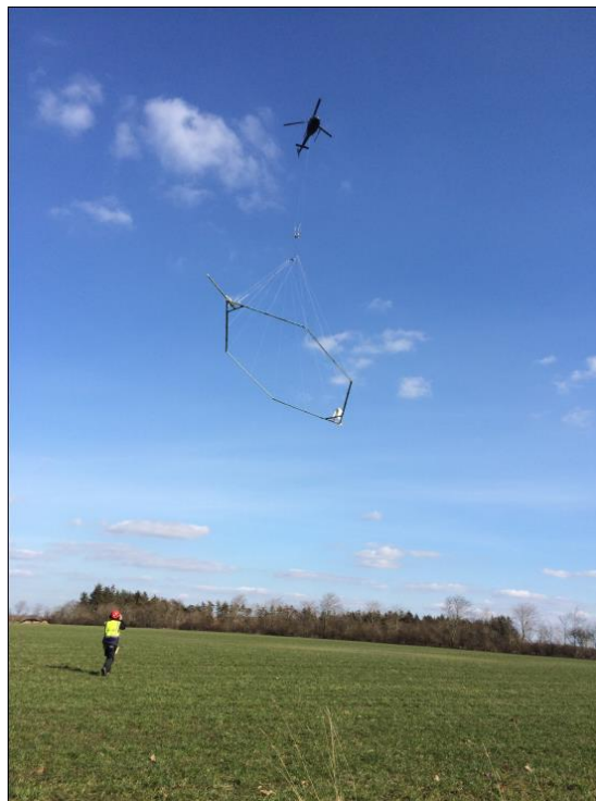
Foto: Helikopter søger efter vandførende lag i undergrunden
